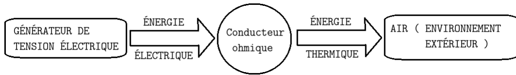
FIGURE 8.8 – Chaîne d'énergie d'un conducteur ohmique
